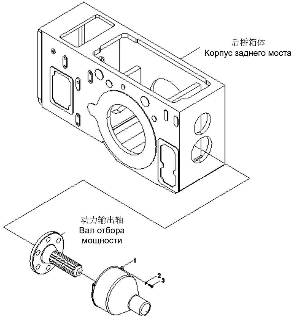
**015712041CAC00000 动力输出总成(4)****015712041CAC00000 Вал отбора мощности в сборе(4)**
