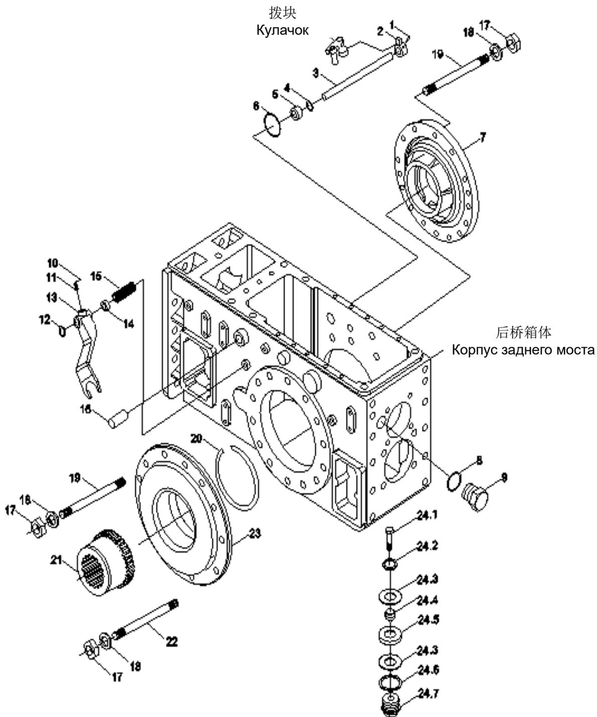
**015714038CAA00000 后桥总成(2)续****015714038CAA00000 Задний мост в сборе(2) (Продолжение)**
